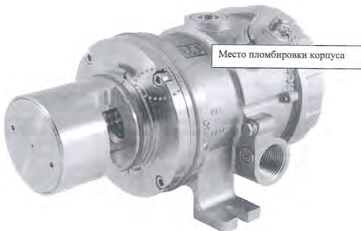
Рисунок 5 - Место пломбировки корпуса газоанализатора для ограничения доступа (на примере СГОЭС-М11 нержавеющей сталь)
